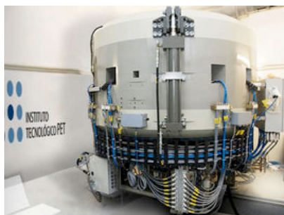
Ciclotrón, utilizado para el diagnóstico por imagen PET-TAC, técnica que requiere la administración intravenosa de un radiofármaco. EFE
